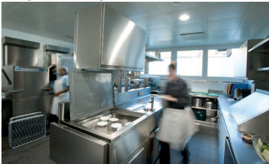
Die Saladière ist mit einer leicht bedienbaren Teleskop-Haube ausgerüstet und lässt sich mit leichter Handbewegung öffnen und schliessen.
